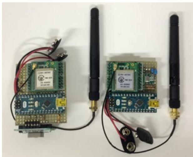
図1 左 テレメトリ装置 (GPS)・右 テレメトリ装置 (大気圧)
